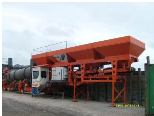
Ilustración 14: Planta asfáltica con filtro de mangas
