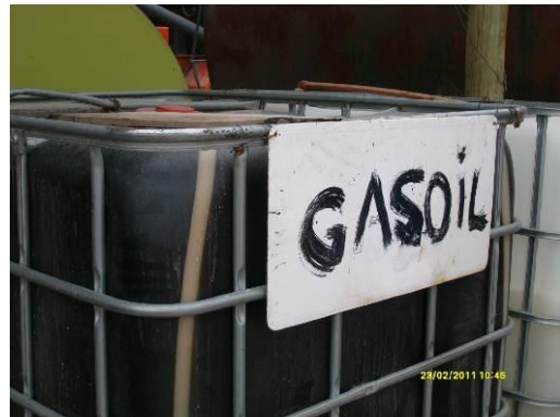
Ilustración 7: Tanque de gasoil sin diques de protección
