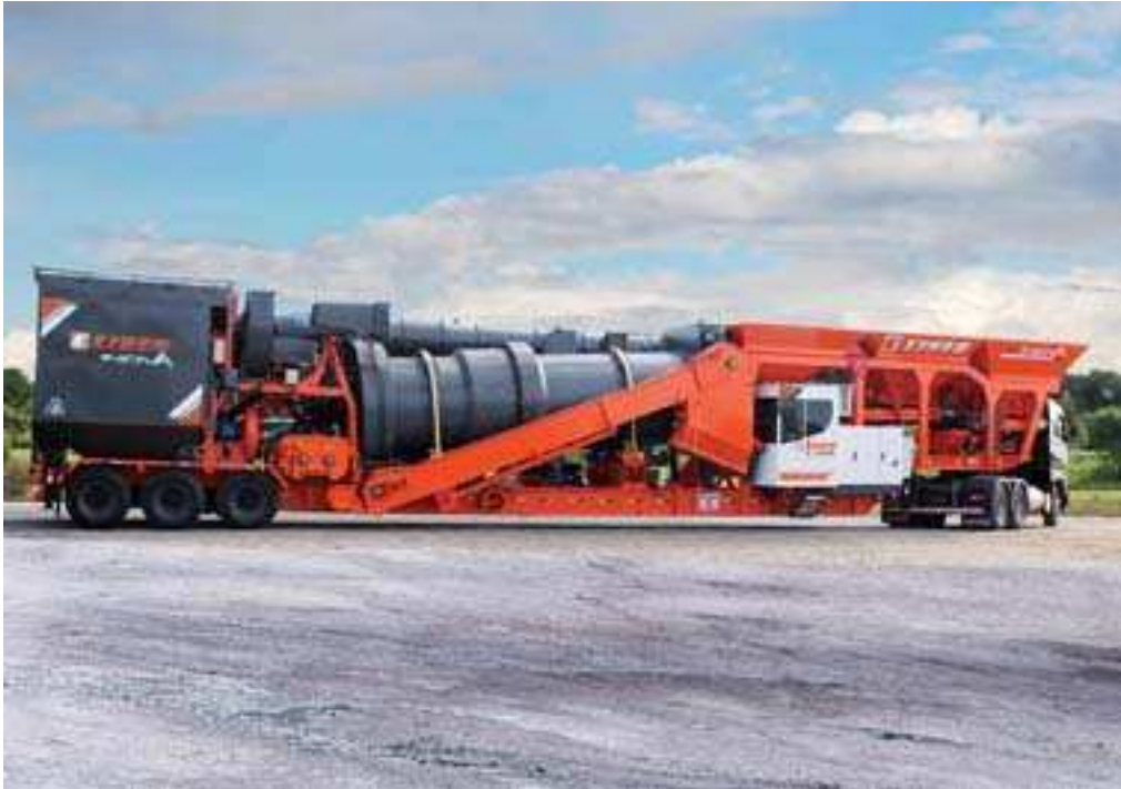
Figura 9: Transporte de planta asfáltica CIBER INOVA 1200-P1
