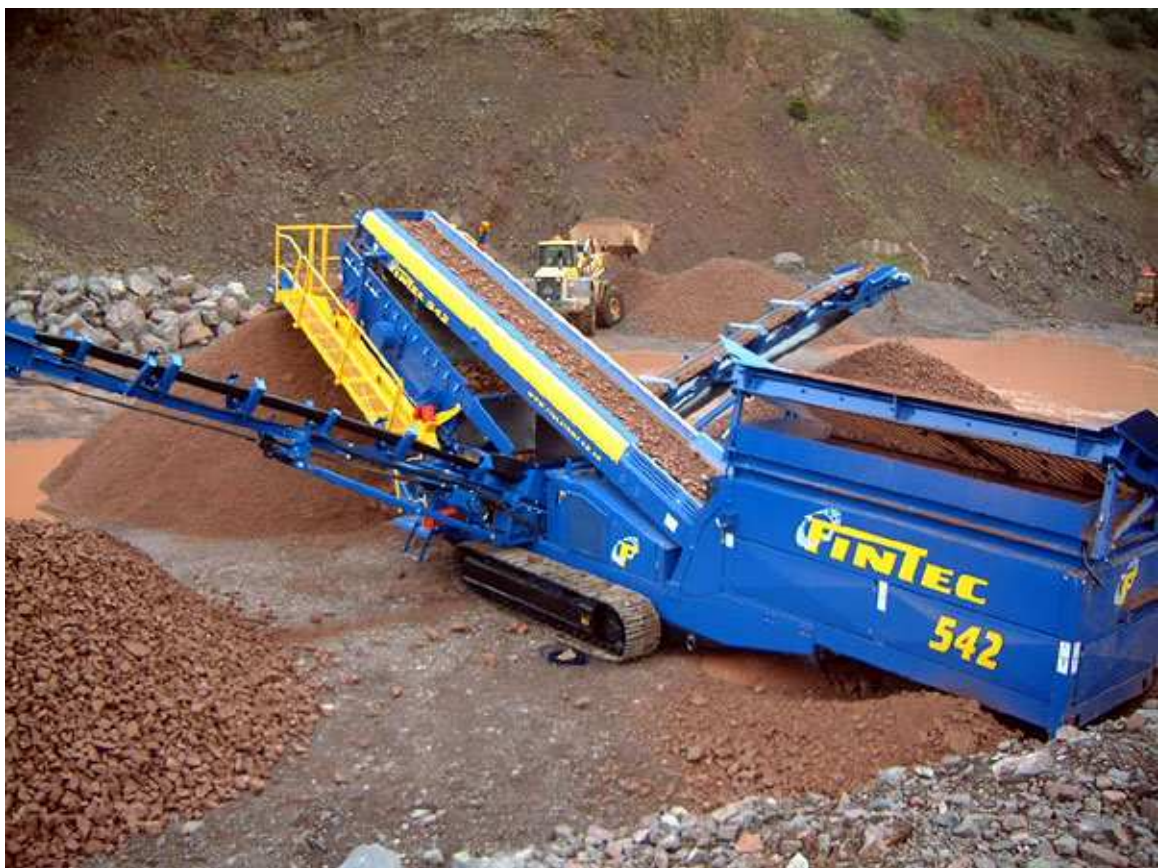
Figura 4: Vista de clasificación por zarandeo con FINTEC 542
