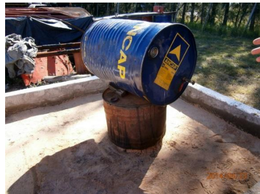
Ilustración 7-Sistema de almacenamiento y contención para solución tensoactiva con gasoil
