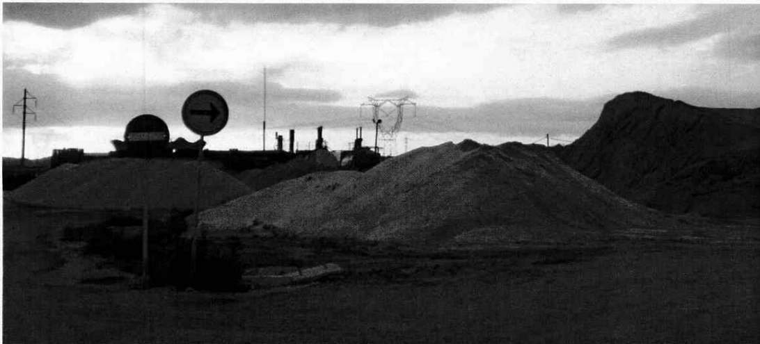
Figura 3-3 Acopio de áridos en planta de asfalto
