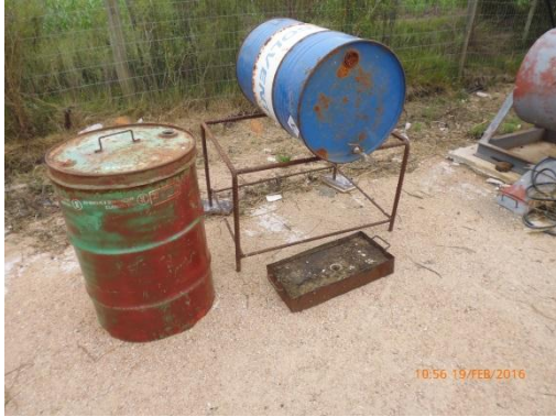
Ilustración 11 – Tanque con percloroetileno en uso sobre bandeja de contención.
