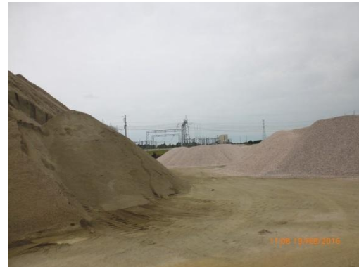
Ilustración 14 – Acopios de áridos para la planta asfáltica.
