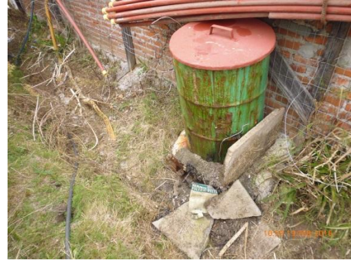
Ilustración 12 – Tanque con percloroetileno usado. Se observa rotura con fugas.
