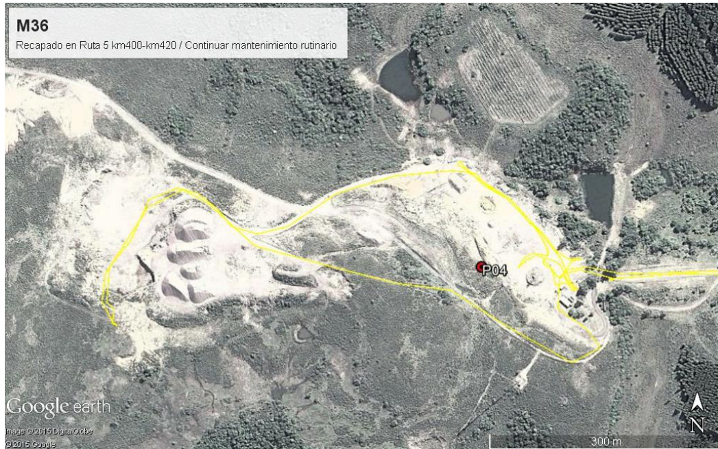
Ilustración 6 - Vista de la zona afectada por cantera y planta trituradora, se aprecia la construcción de represas de sedimentación.
