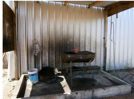
Ilustración 22-Pileta de lavado de piezas con hidrocarburos en obrador Ruta 26, Villa Ansina
