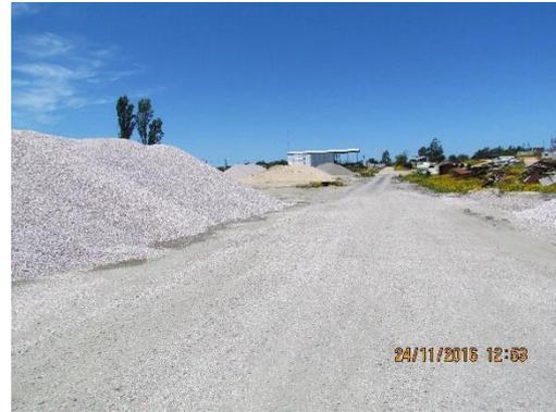
Ilustración 13 - Acopio de áridos en planta asfáltica
