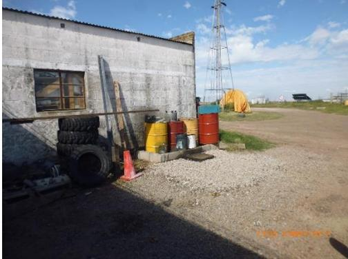
Ilustración 11 - Obrador. Tanques de aceite usado en zona de contención y cámara de separación. Pedregullo en el perímetro.
