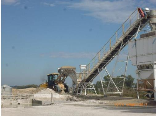
Ilustración 23 - Planta de hormigón. Carga de áridos.
