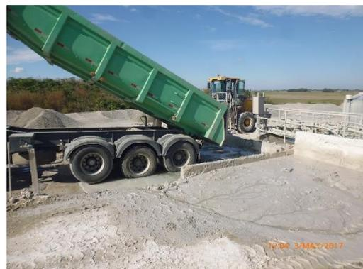
Ilustración 22 - Planta de hormigón. Camión lavando en pileta de lavado.
