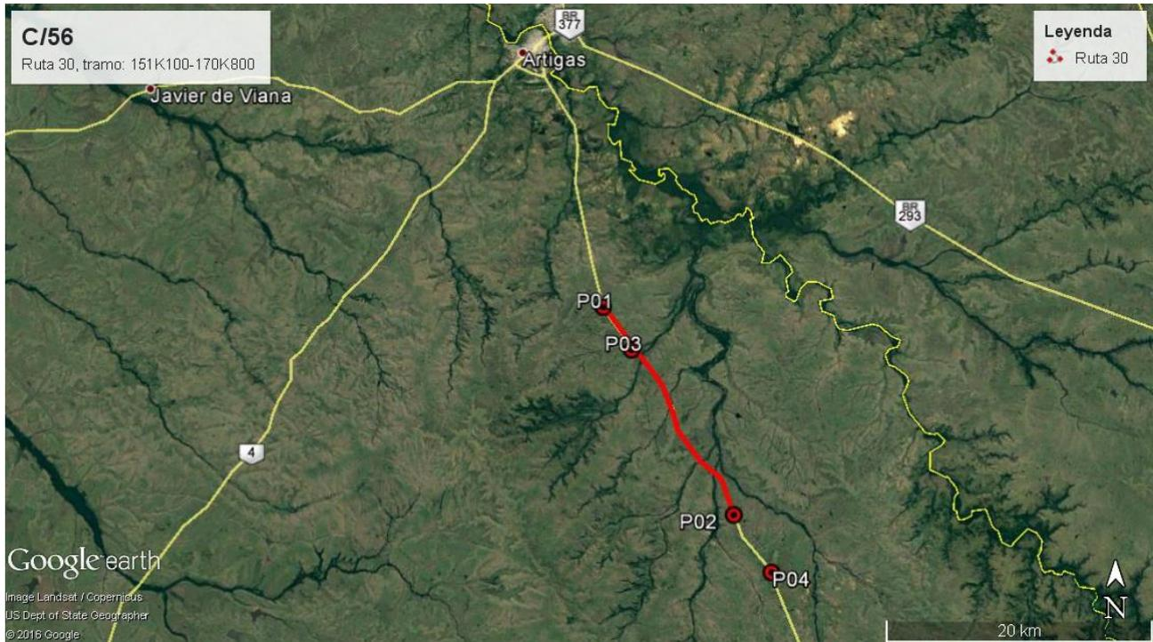
Ilustración 3 - Puntos destacados sobre el tramo de ruta 30: P01 y P02 inicio y fin del contrato. P03 estacionamiento transitorio y P04 obrador.
