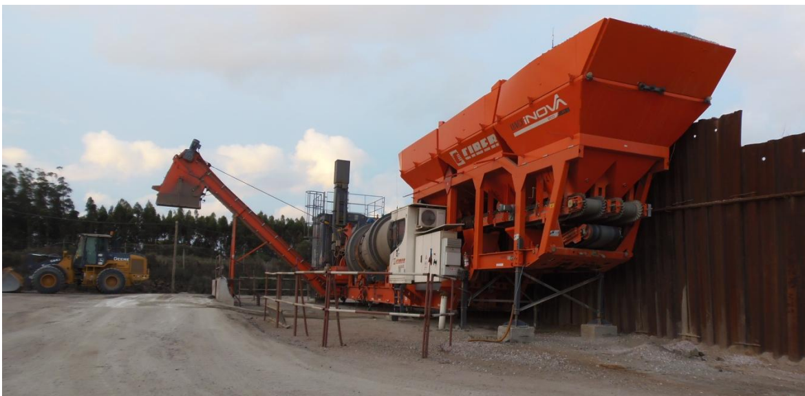
Figura 4-2 Planta de asfalto
