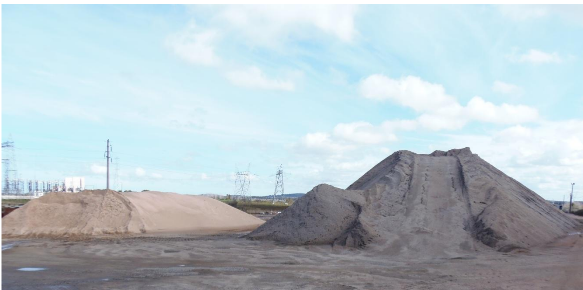
Figura 3-1 Acopio de áridos en planta de asfalto
