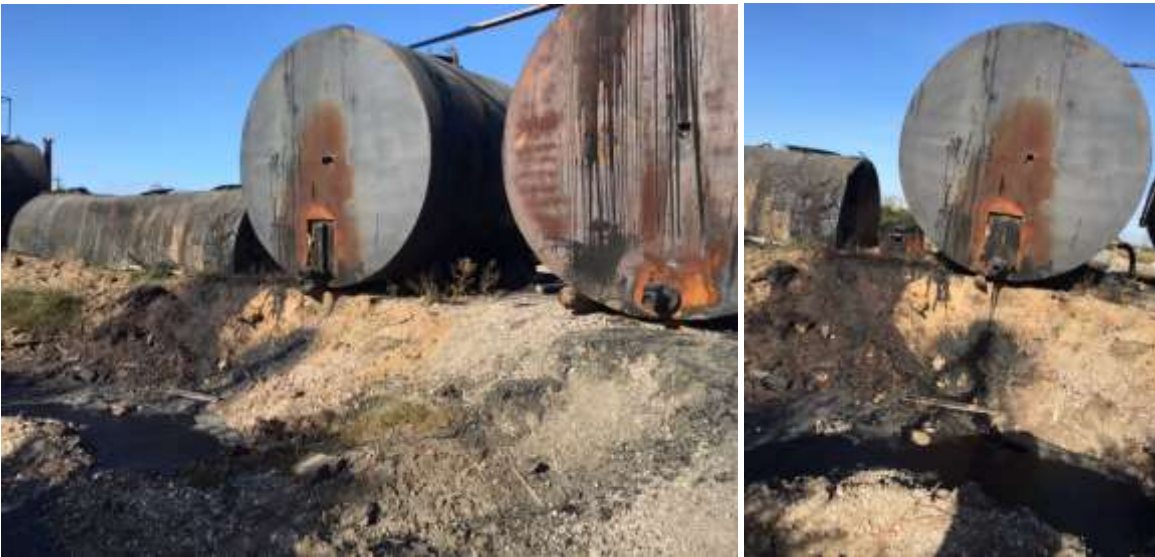
Figura 8-1 Derrame de emulsión asfáltica
