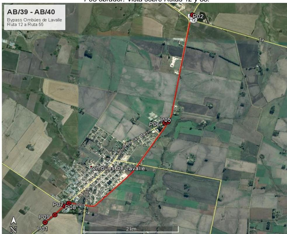
Ilustración 4 - Puntos intermedios de la ampliación 2. P05 y P06: rotonda y acceso norte. P07 y P08: rotonda y acceso sur.
