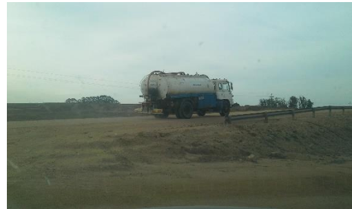
Ilustración 25 - Frente Obras. Camión regador de agua para caminos.
