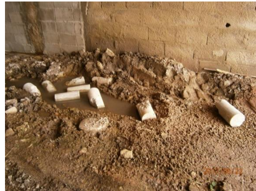
Ilustración 6 – Depósito con restos de probetas de hormigón.
