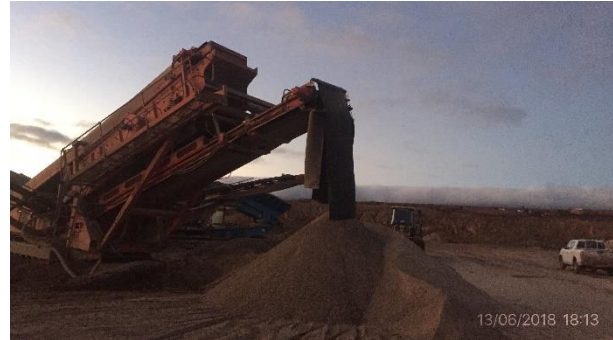
Ilustración 11 - Trituradora de áridos con manga de goma
