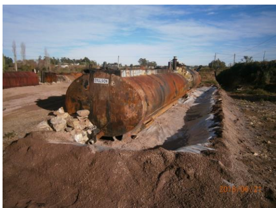
Ilustración 8 - cisterna de emulsión asfáltica.
