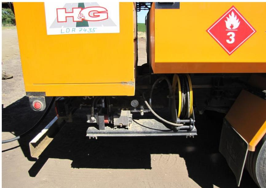
**Lanza de succión, tanque de depósito.**
