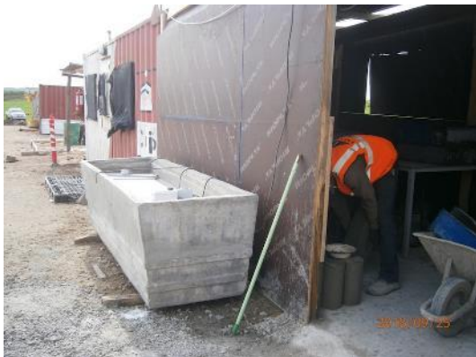
Ilustración 12 - probetas de hormigón.
