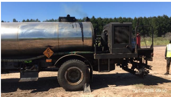
Ilustración 8 – Campamento provisorio – Camión regador: no hay sistema de retención de derrames
