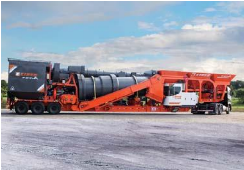
Figura 10: Transporte de planta asfáltica CIBER INOVA 1200-P1
