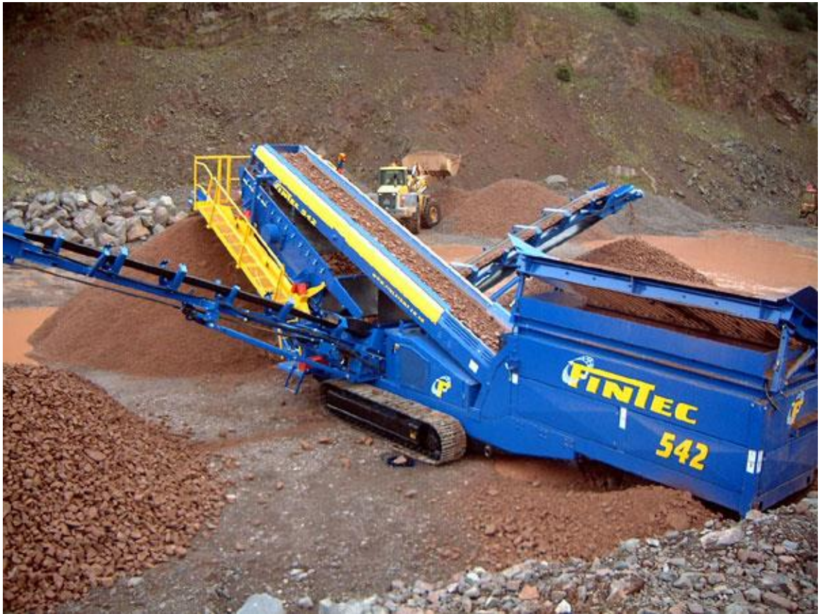
Figura 5: Vista de clasificación por zarandeo con FINTEC 542
