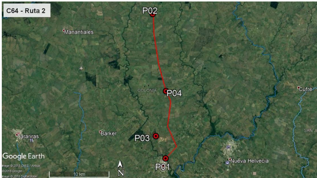
Ilustración 3 - Puntos destacados del contrato. P01 y P02 inicio y fin del contrato, P03 Obrador y cantera. P04 frente de obras
