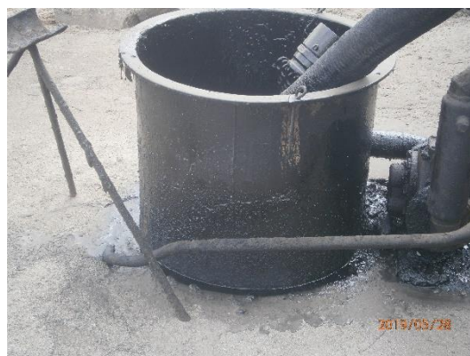
Ilustración 14 – Tanque de trasvaso de mezcla asfáltica
