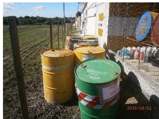
Ilustración 9 – Sector de Acopio de residuos categorizados clase I decreto 182/13
