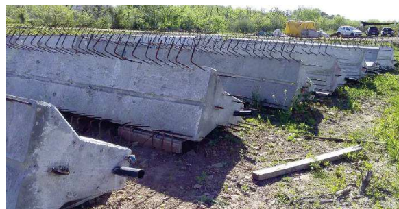
Imagen 4, 5 y 6 – Defensas New Jersey prefabricadas
